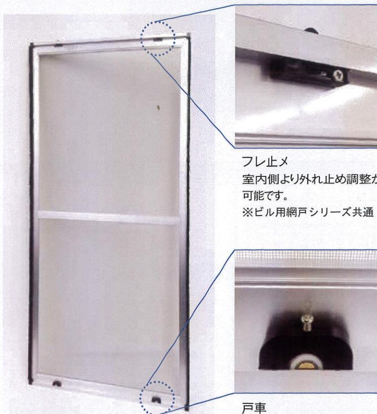
従来の102B型と違い、横材の全フレームがサッシ枠へ掛かるため、サッシ枠と網戸本体との隙間を解消。
